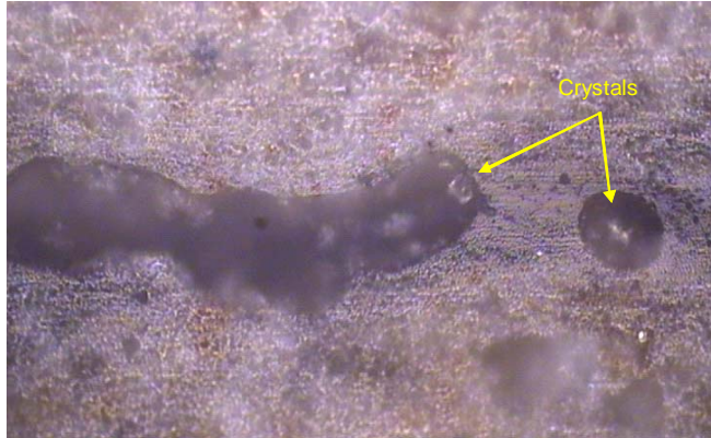
Fotografía del SikaSeal®-250 Migrating, por microscopía óptica
